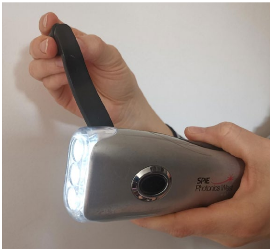
Llanterna sense piles carregada segons la llei de Faraday.
