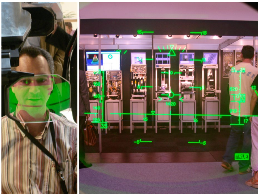
Visor hologràfic, consistent en la projecció sobre un espill hologràfic d'informació que l'observador, sense necessitat de moure el cap, veu superposada sobre els objectes de l'exterior.
