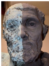
Ús del làser per a eliminar la corrosió sobre una escultura de bronze. Font: Philamuseum.tumblr.com .
