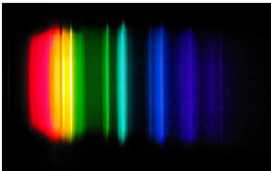
Espectre (discontínu) d'un llum de sodi d'alta pressió. Foto: C. Heilman (CC BY-SA 3.0).
